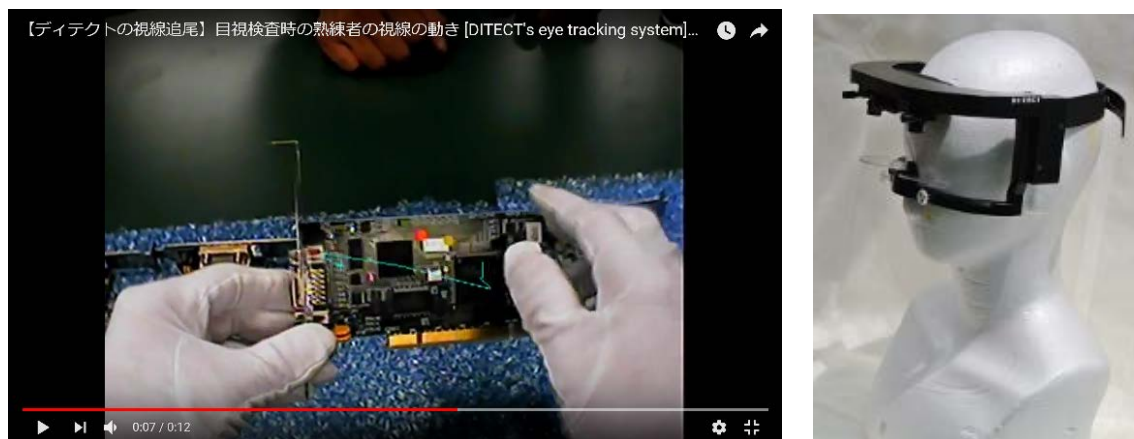
【図表 3-4】 熟練者の目視検査での視線の動きを ViewTracker II にて記録
